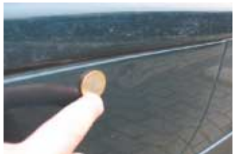
Dit is een voorbeeld van een acceptabele beschadiging. Het deukje is kleiner dan een euromunt en er is slechts één schade.
