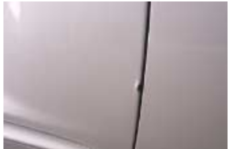
Dit is een niet acceptabele schade aan de lak. Roestvorming is opgetreden.
