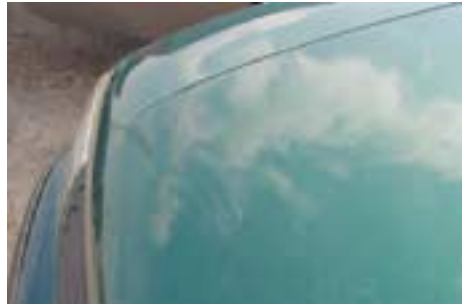
Dit is een niet acceptabele schade aan de lak, ontstaan door reinigen met een schuurspons.
