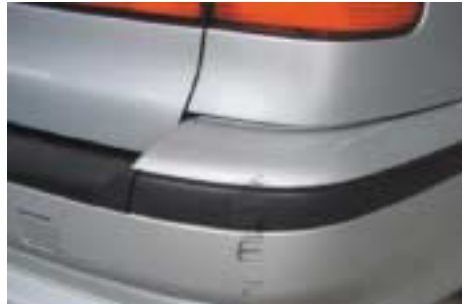
Dit is een niet acceptabele beschadiging van de bumper. De krassen zijn door de lak heen.
