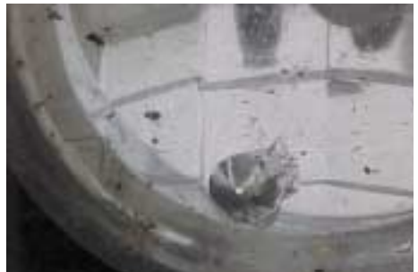
Deze beschadiging aan de lamp is niet acceptabel. De beschadiging is het gevolg van steenslag. Een dergelijke beschadiging leidt tot afkeuring van de APK.
