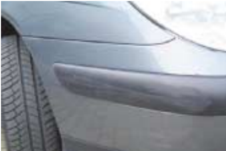
Dit is een niet acceptabele beschadiging van de bumper. De krassen zijn ontstaan door een aanrijding.
